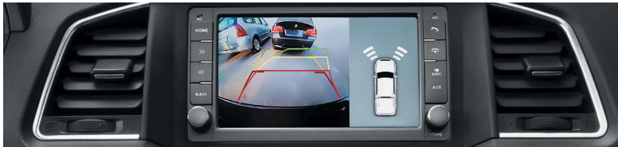
Durante la marcha atrás, en la pantalla en color se muestra la imagen de la cámara retrovisora con las líneas dinámicas y el funcionamiento de los sensores de estacionamiento traseros y delanteros
