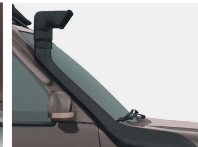
Toma de aire (snorkel) elevada
