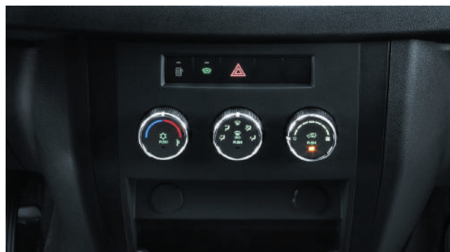
La buena planificación de la ubicación de los módulos del climatizador permite al conductor manejar el vehículo de modo seguro sin perder de vista la trayectoria
