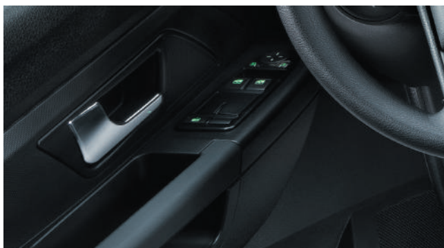
Control del mecanismo eléctrico de los eleválunas y de los espejos externos en la puerta del conductor
