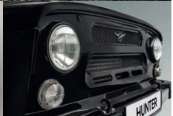
Una fina parilla metálica protege al radiador contra la agresividad del medio exterior
